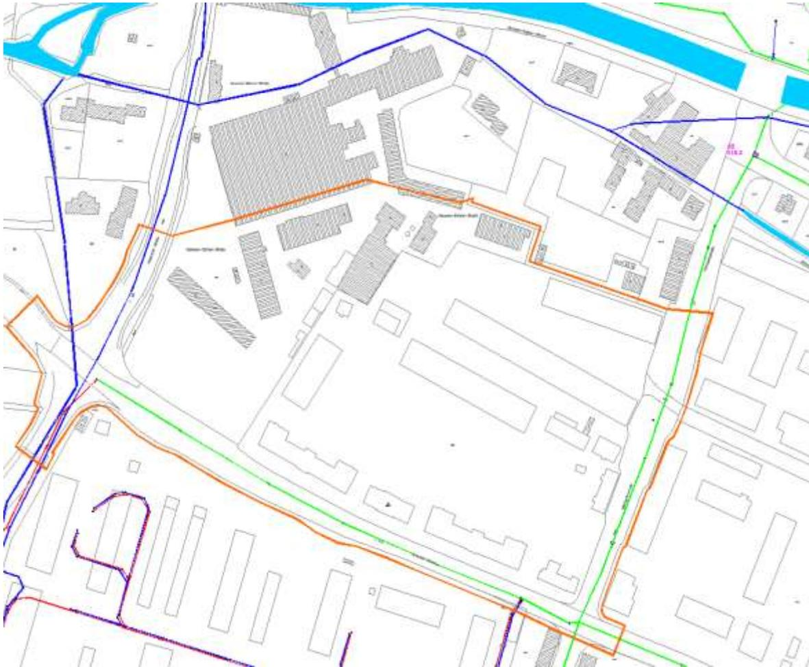
Kanalisation im Umfeld des Baugebiets (Mischwasserkanäle = grün, Regenwasserkanäle = blau, Schmutzwasserkanäle = rot)
