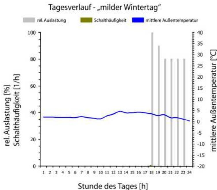
Abbildung A1-12: Tagesverlauf der relativen Auslastung für die Verfeuerung von Stückholz in Zusatzfeuerungen an einem milden Wintertag (aus: Baumbach et al. (2010), Bild 3-50, S. 74).
