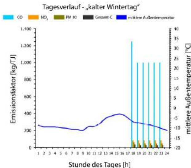
Abbildung A1-11: Tagesverläufe von Emissionsfaktoren für die Verfeuerung von Stückholz in Zusatzfeuerungen an einem kalten Wintertag (aus: Baumbach et al. (2010), Bild 3-72, S. 92).
