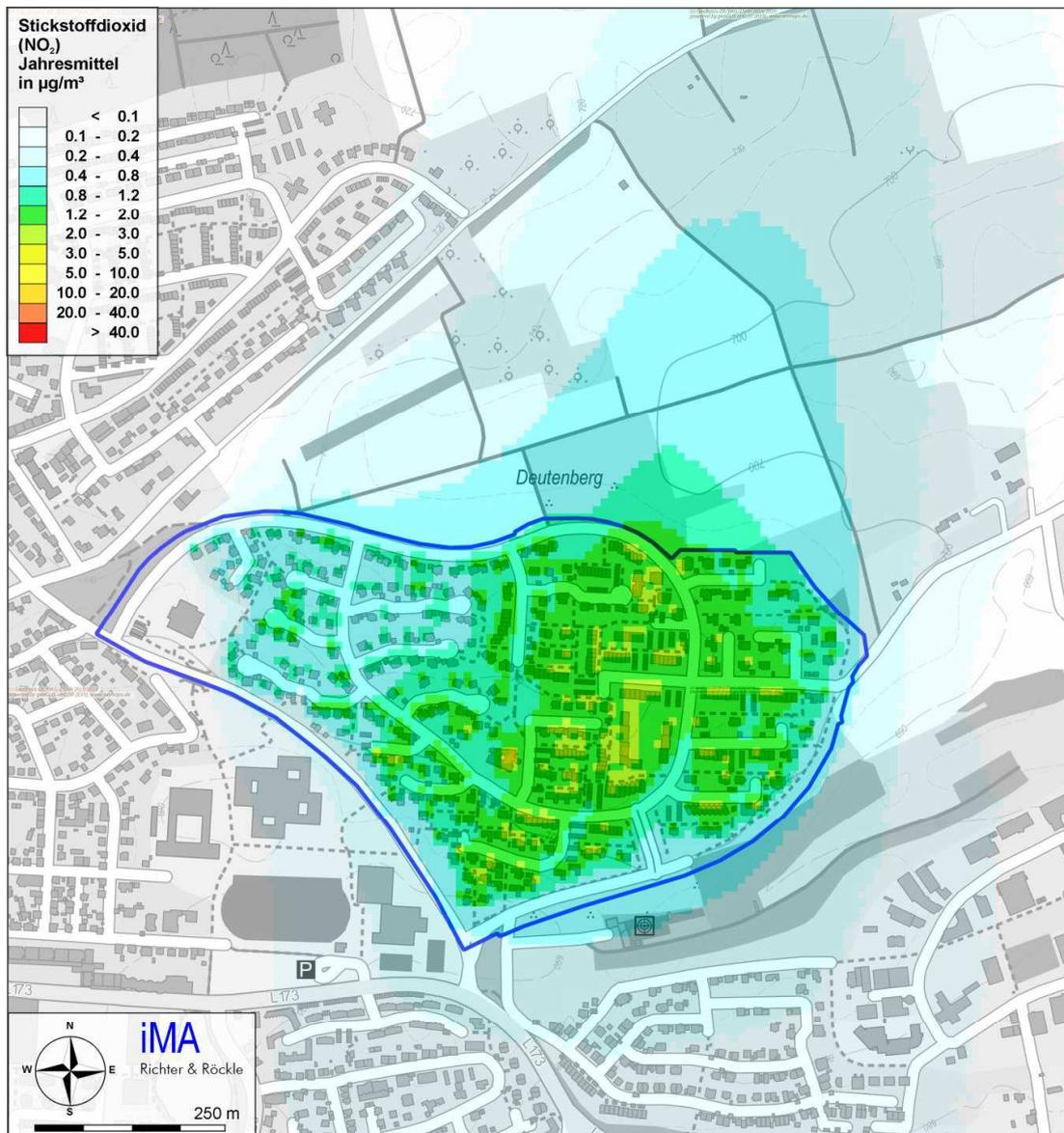
Abbildung 11-9: Berechnete NO<sub>2</sub>- Jahresmittelwerte in µg/m<sup>3</sup> bei Verfeuerung von Stückholz in Kesseln mit Pufferspeicher und Zusatzfeuerungen. Grenzwert 40 µg/m<sup>3</sup>.
