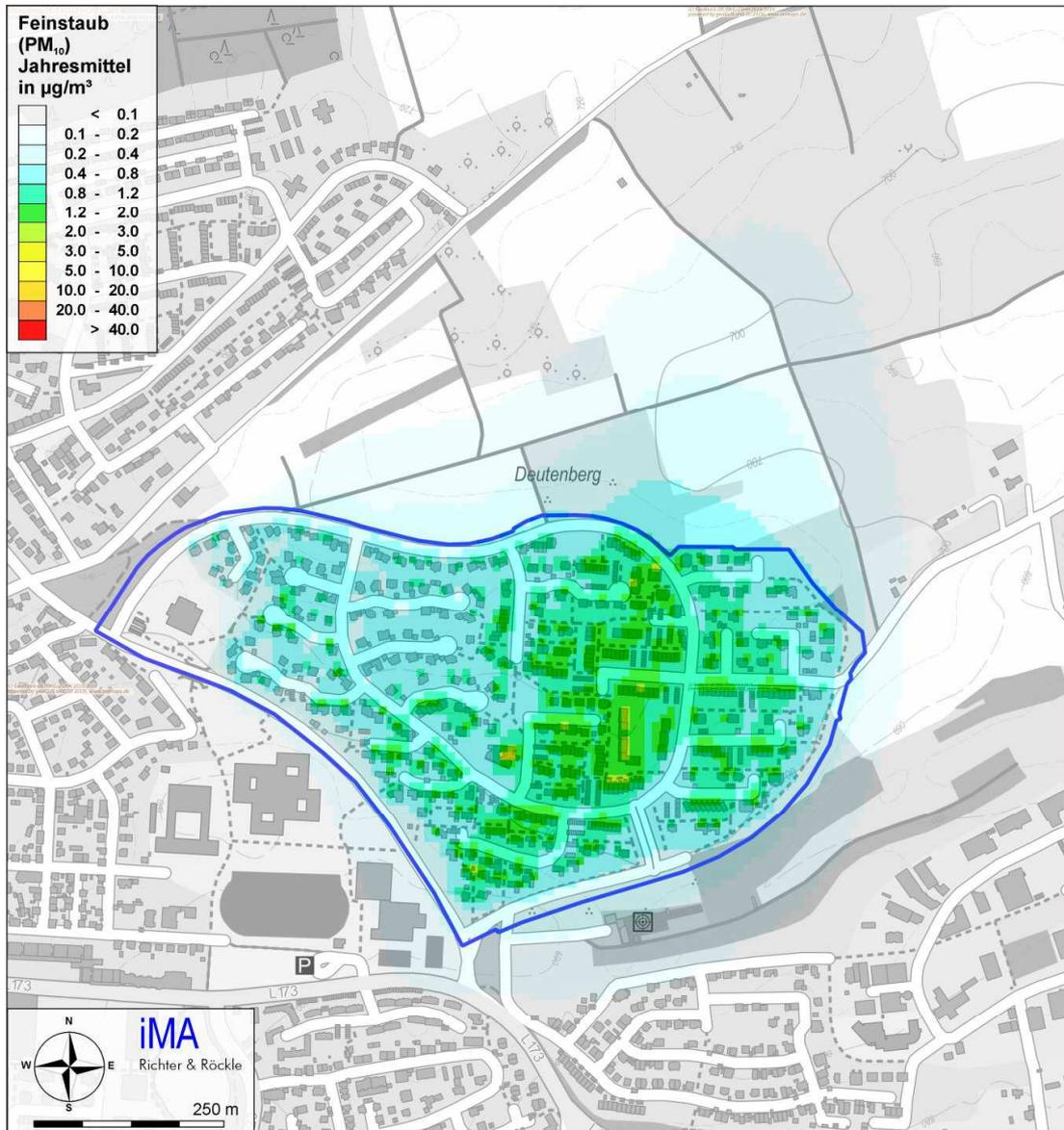
Abbildung 11-3: Berechnete PM<sub>10</sub>- Jahresmittelwerte in µg/m<sup>3</sup> bei Verfeuerung von Stückholz in Zusatzfeuerungen. Grenzwert 40 µg/m<sup>3</sup>.
