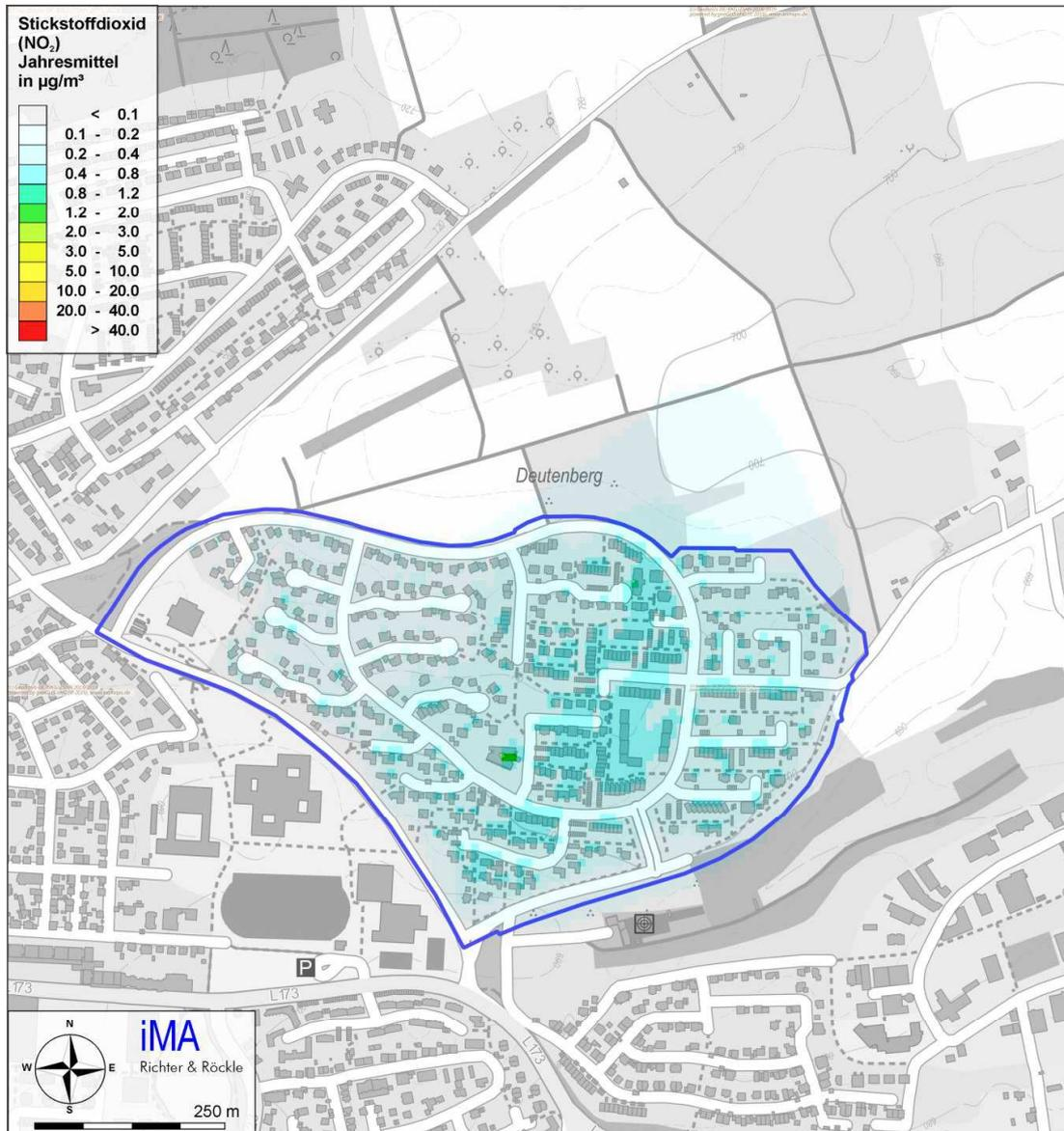
Abbildung 11-8: Berechnete NO<sub>2</sub>- Jahresmittelwerte in µg/m<sup>3</sup> bei Verfeuerung von Stückholz in Zusatzfeuerungen. Grenzwert 40 µg/m<sup>3</sup>.
