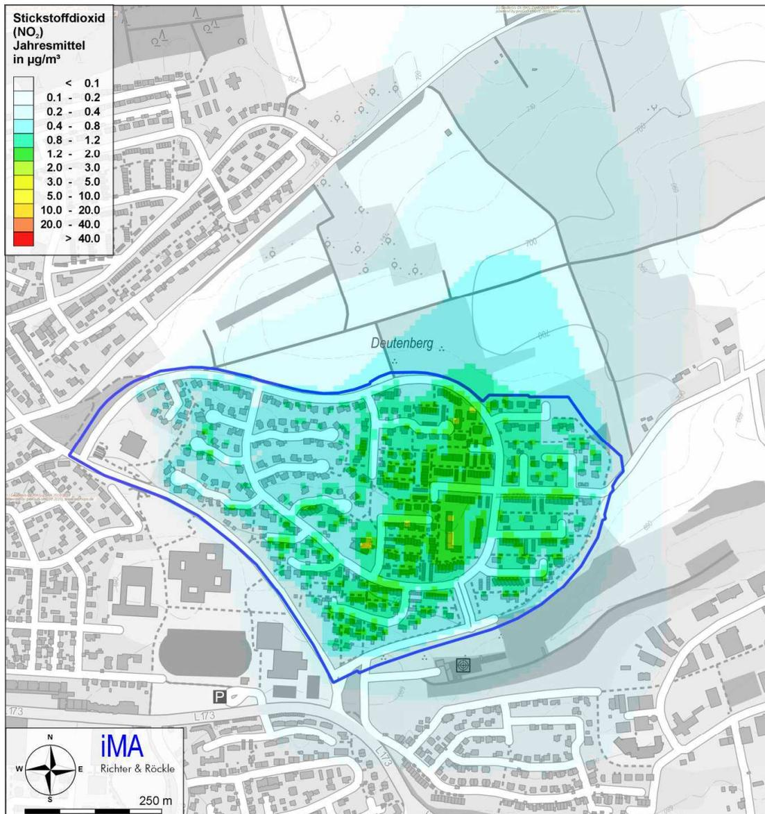
Abbildung 11-6: Berechnete NO<sub>2</sub>- Jahresmittelwerte in µg/m<sup>3</sup> bei Verfeuerung von Pellets. Grenzwert 40 µg/m<sup>3</sup>.
