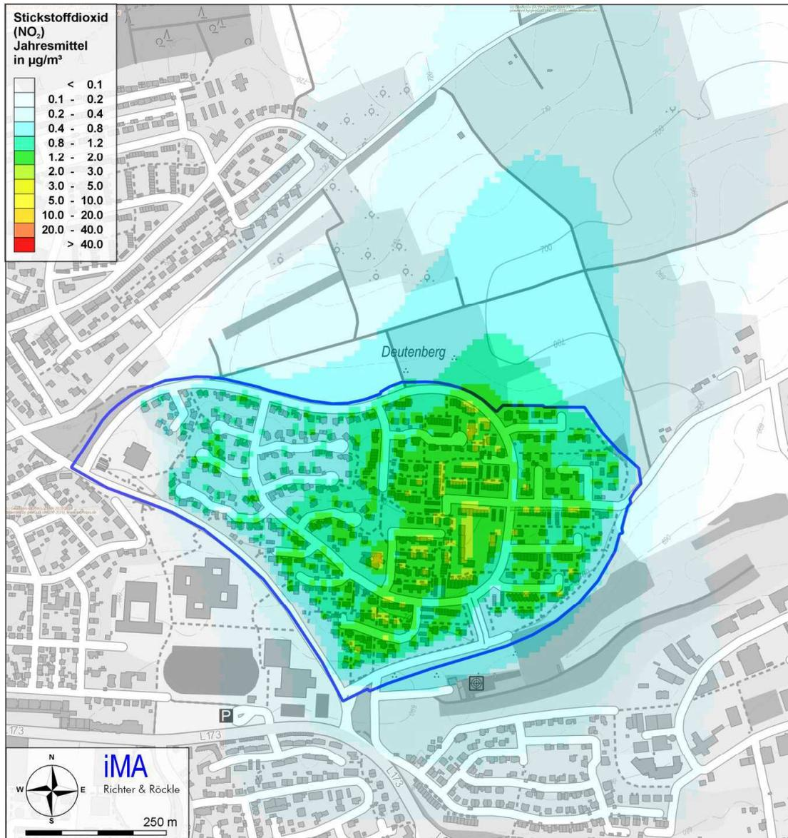
Abbildung 11-7: Berechnete NO<sub>2</sub>- Jahresmittelwerte in µg/m<sup>3</sup> bei Verfeuerung von Stückholz in Kesseln mit Pufferspeicher. Grenzwert 40 µg/m<sup>3</sup>.
