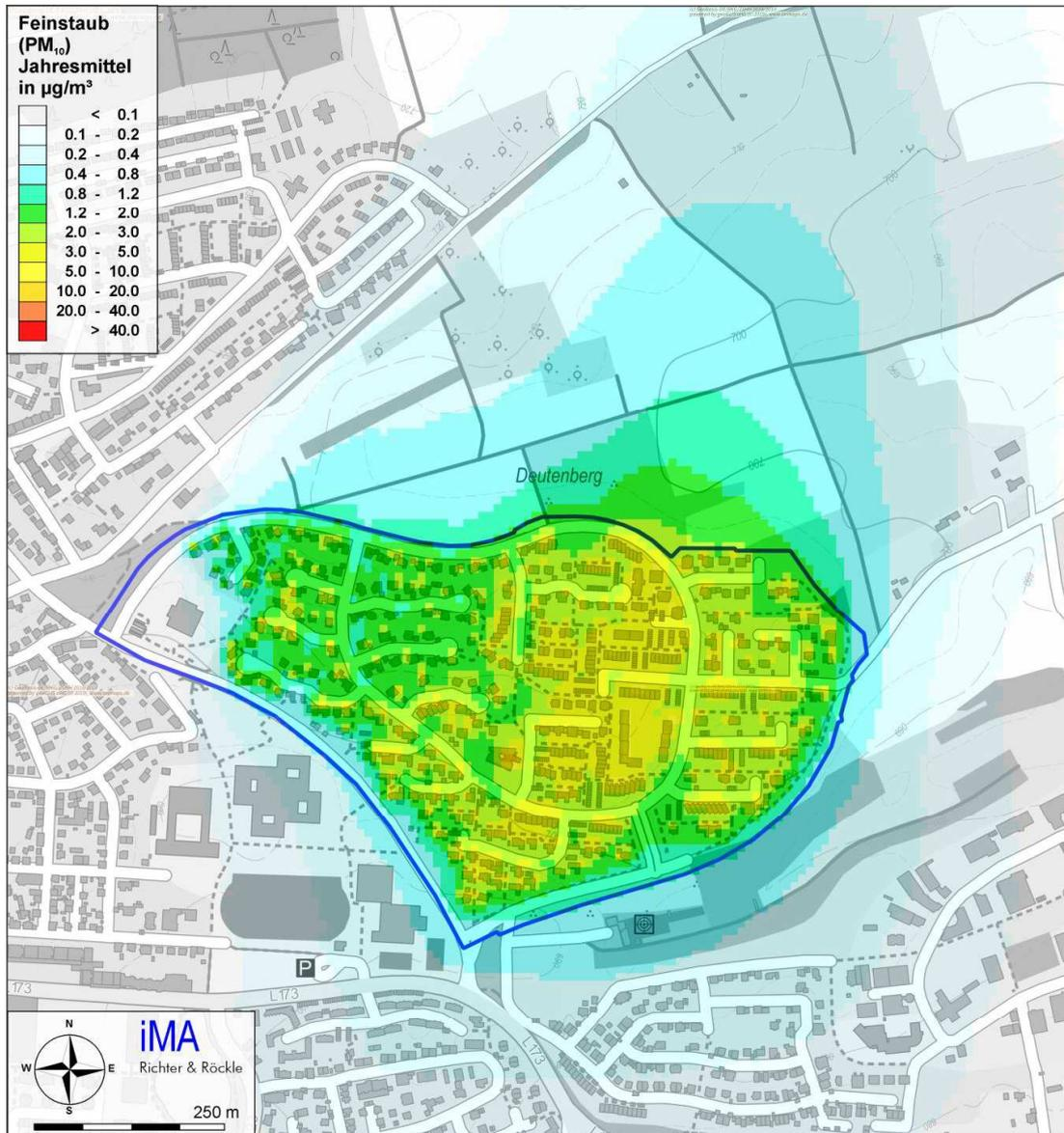
Abbildung 11-4: Berechnete PM<sub>10</sub>- Jahresmittelwerte in µg/m<sup>3</sup> bei Verfeuerung von Stückholz in Kesseln mit Pufferspeicher und in Zusatzfeuerungen. Grenzwert 40 µg/m<sup>3</sup>.
