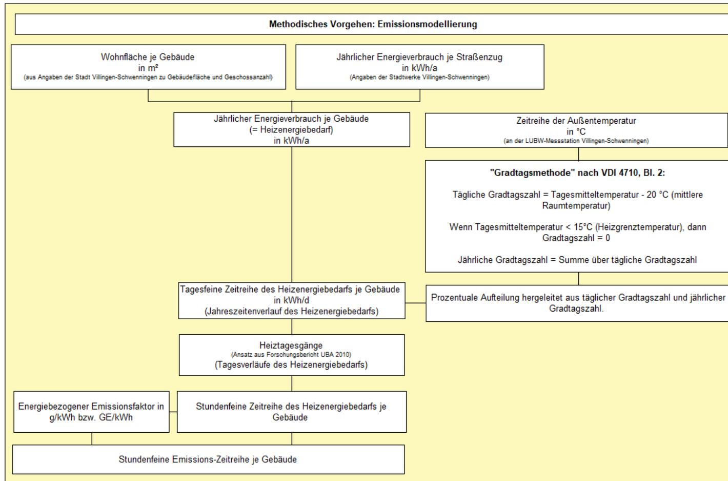
Abbildung 4-1: Fließbild zur Vorgehensweise bei der Emissionsmodellierung.
