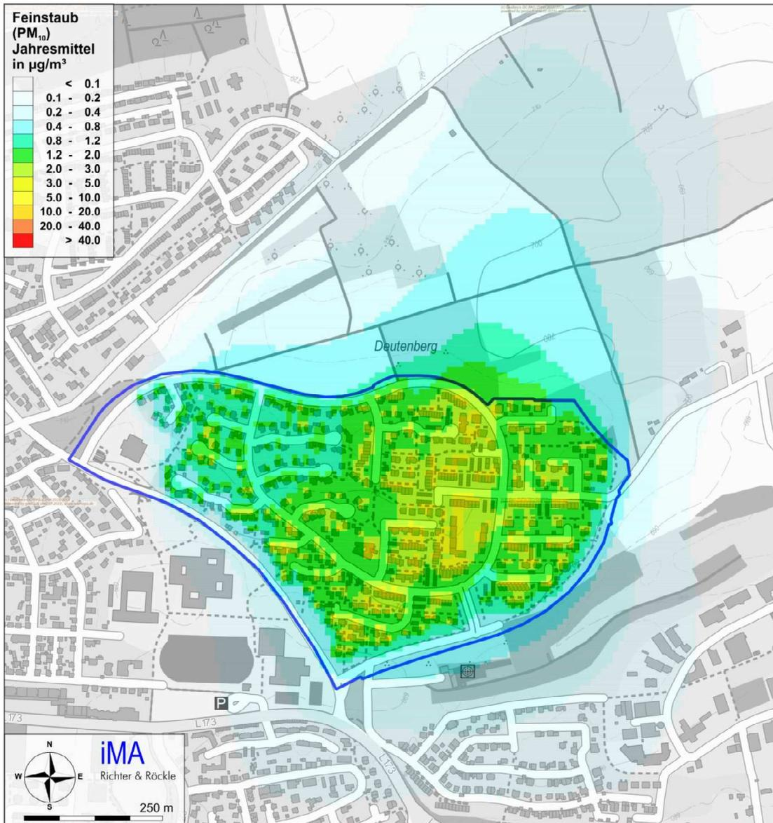
Abbildung 11-1: Berechnete PM<sub>10</sub>- Jahresmittelwerte in µg/m<sup>3</sup> bei Verfeuerung von Pellets. Grenzwert 40 µg/m<sup>3</sup>.
