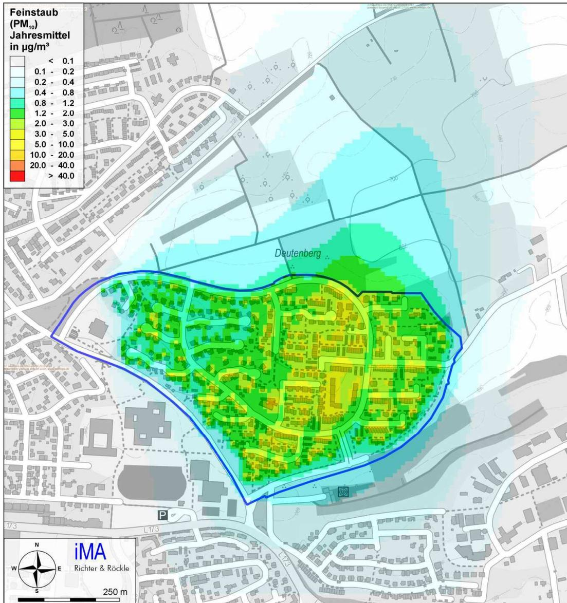
Abbildung 11-2: Berechnete PM<sub>10</sub>- Jahresmittelwerte in µg/m<sup>3</sup> bei Verfeuerung von Stückholz in Kesseln mit Pufferspeicher. Grenzwert 40 µg/m<sup>3</sup>.
