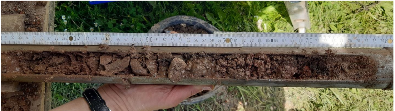
Abbildung 9 Kiesige Quartäre Talfüllung in 3 – 4 m Tiefe
