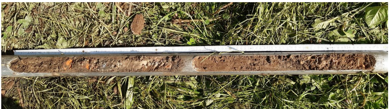
Abbildung 6 exemplarischer Bohrkern (RKS 8) der Auffüllung bis 2 m Bohrtiefe
